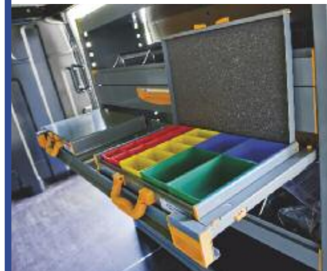
Nella pagina a fianco e sopra, due immagini dell'ECODAILY con le portiere aperte per mettere in evidenza le scaffalature interne. Qui a fianco, un particolare delle cassettiere
