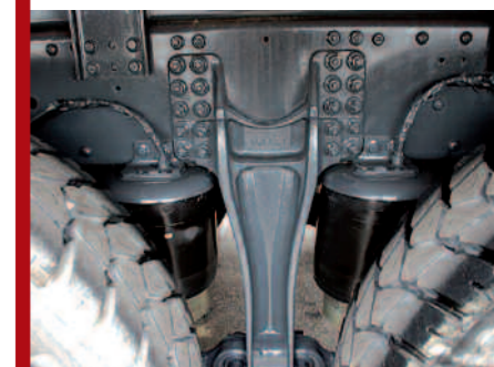
Nella pagina a fianco, un momento del test nell'hinterland torinese e, qui sotto, un guado in cava. Sopra dall'alto, tre particolari: la plancia con, a destra, i comandi del cambio automatizzato EuroTronic 2; il cluster con l'indicazione del peso sugli assi posteriori; un primo piano delle sospensioni pneumatiche
