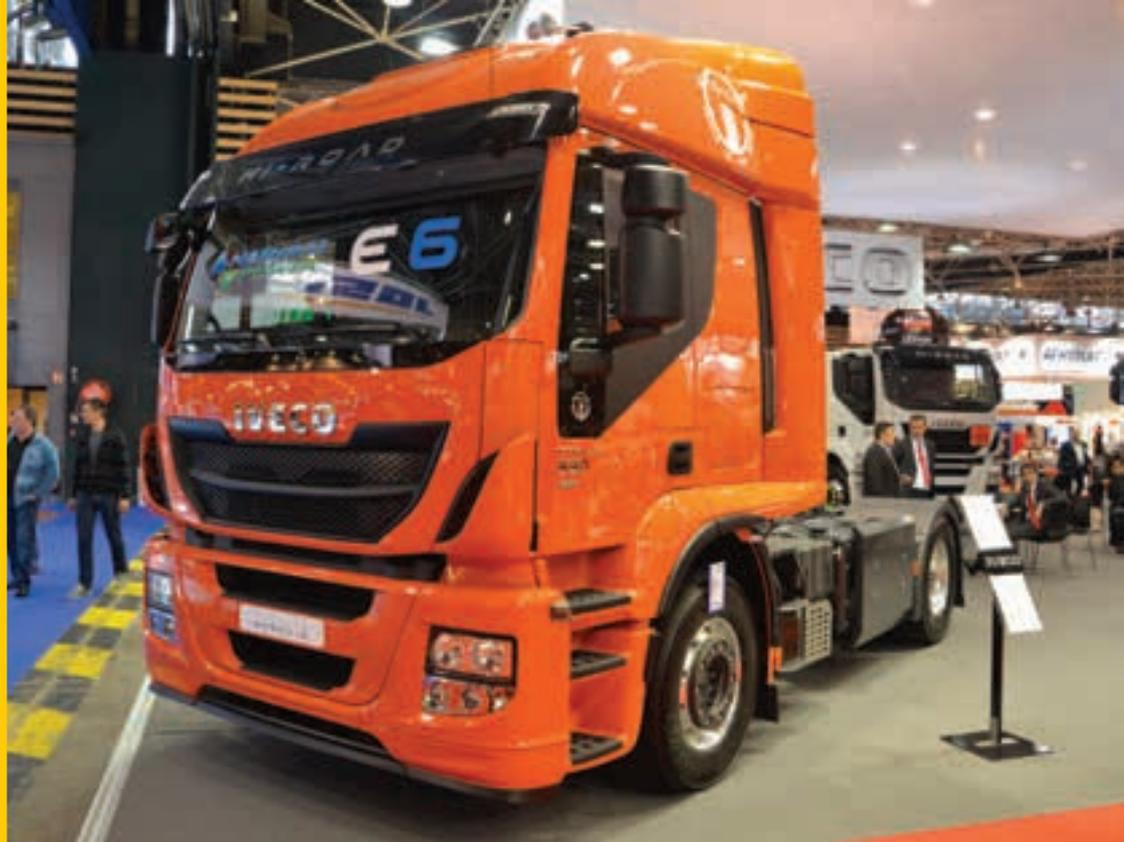
Sopra, uno Stralis Natural Power con doppia alimentazione a gas naturale compresso (CNG) e liquefatto (LNG), esposto al Solutrans di Lione
