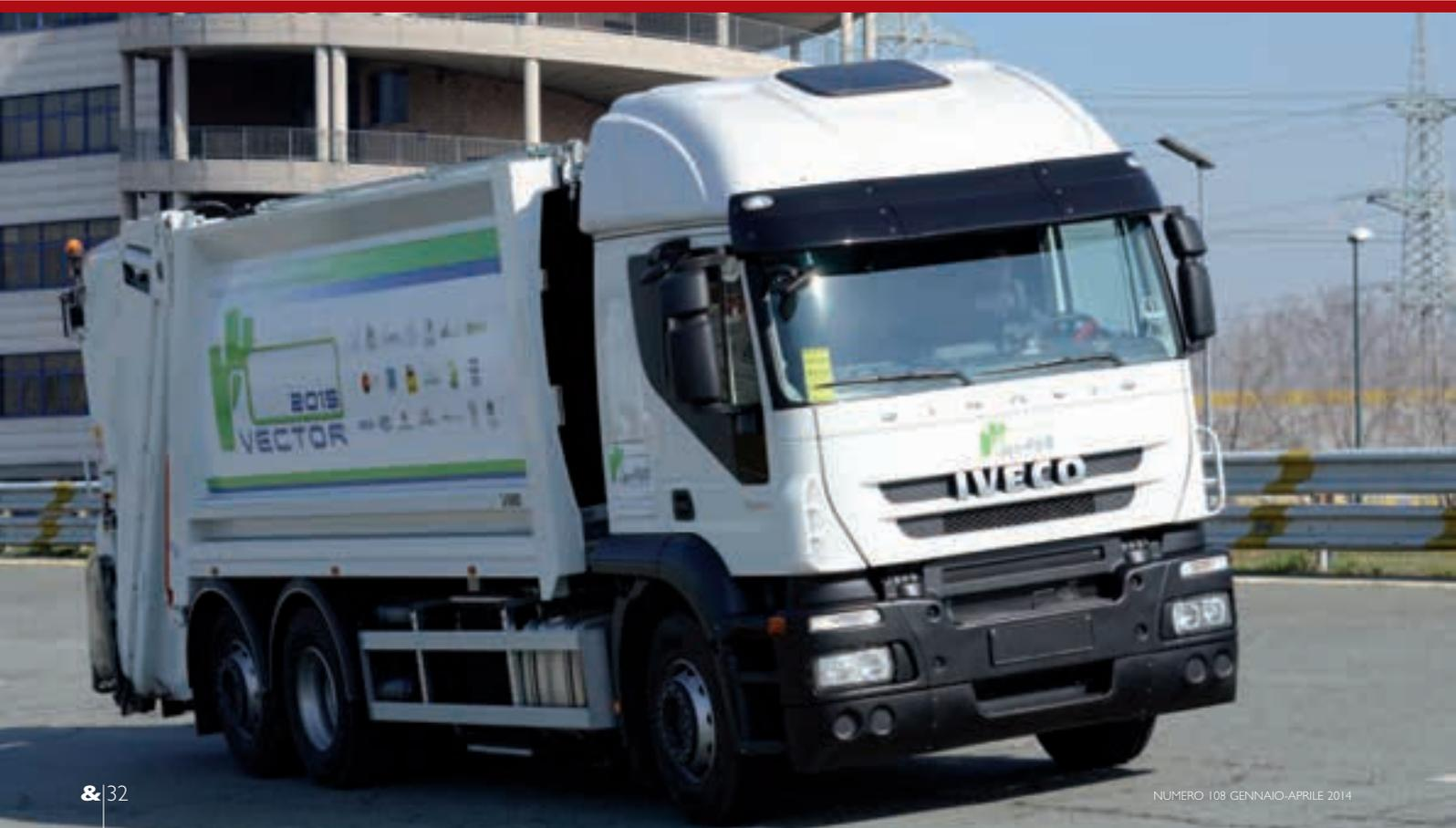
lometri l'ora. Oltre questo limite, quando, la trazione idrostatica diventa inefficiente dal punto di vista energetico, subentra automaticamente una connessione meccanica diretta fra il motore diesel e le ruote. In fase di rallentamento, le due pompe secondarie inviano il fluido ai due accumulatori, ricaricandoli (frenata rigenerativa). In questo modo è possibile recuperare fino al 70 per cento dell'energia di decelerazione del veicolo che, altrimenti, verrebbe dissipata sotto forma di calore.
